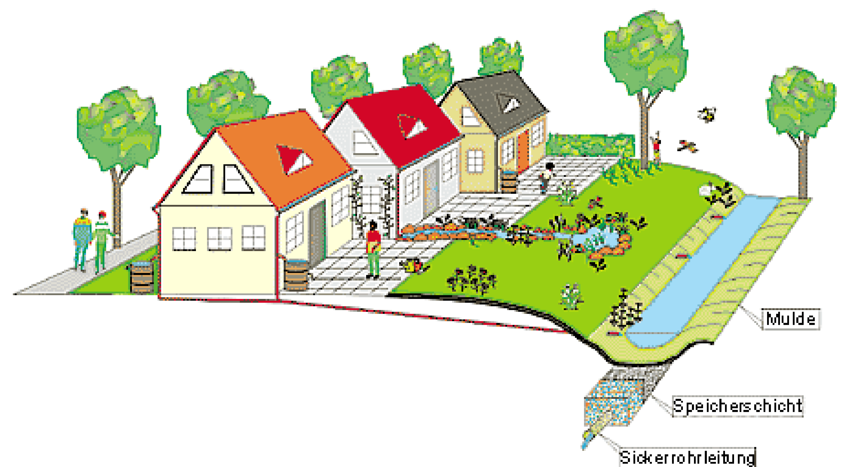
Abbildung 4 und 5: Dezentrale Regenwasserversickerung durch Straßengeleitende Mulden und Rigolen-Systeme
